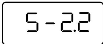
2 秒后进入自动模式运行，显示数据查询界面，显示本机组网地址。
