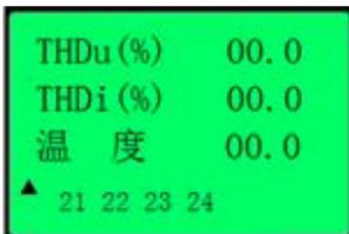
第四屏 显示 3、5、7 次电压、电流谐波畸变率。
